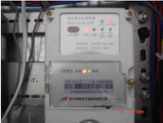
图 7 指示灯显示红色时，GPRS 信号很弱，一般在 -85 db 以下
