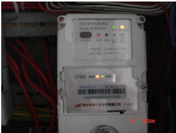
图 6 指示灯显示橙色时，GPRS 信号中等，一般在 -65—85db 之间
